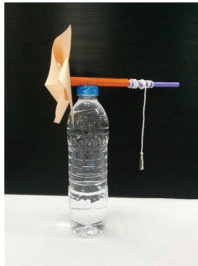
1.6 นำกังหันลมไปทดสอบการหมุนตัวยังแรงลม เพื่อสังเกตการหมุนของกังหันลมและการเคลื่อนที่ของคลิปหนีบกระดาษ
