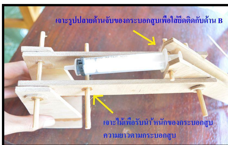
12. นำกระบอกฉีดยามาทาบกับแบบแล้วทำเครื่องหมายเพื่อเจาะรูยึดกระบอกฉีดยา
