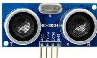
รูปที่ 2 ภาพโมดูลอัลตราโซนิคโมเดล HC-SR04
