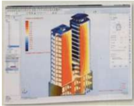
แบบจำลองทางคอมพิวเตอร์ ทดสอบการทนต่อแรงลมของอาคาร
