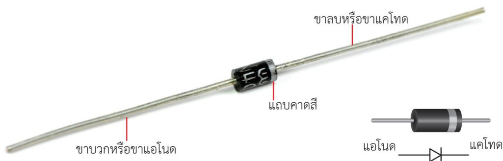
ภาพที่ 2 ไดโอดแบบธรรมดาและสัญลักษณ์ในวงจรไฟฟ้า
