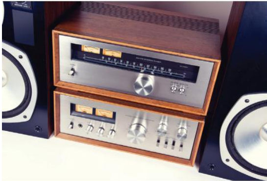
ก. ปุ่มปรับความดังของเสียงในเครื่องเสียง ข. ปุ่มปรับความสว่างในวงจรหรี่ไฟ ภาพที่ 5 ตัวอย่างการใช้งานตัวต้านทานแปรค่าได้ในชีวิตประจำวัน
