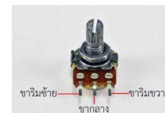
ภาพที่ 2 ตัวต้านทานแปรค่าได้และสัญลักษณ์ในวงจรไฟฟ้า
