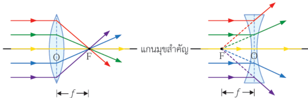
ภาพที่ 4 การหักเหของแสงผ่านเลนส์
