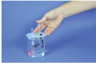
ภาพการดันหลอดแก้วและจุกยางออกทางด้านล่างของฝาครอบ
