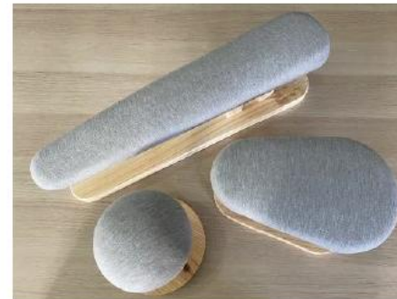
หมอนรองรีด ใช้รีดบางส่วนของเสื้อหรือตะเข็บที่มีส่วนเว้าโค้ง
