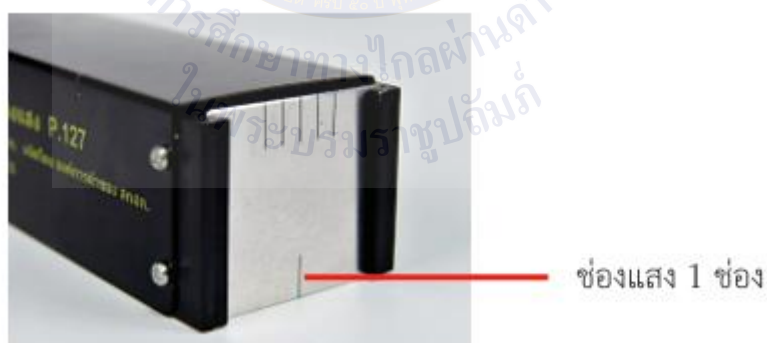
ภาพที่ 2 แสดงการสอดแผ่นช่องแสงที่ให้ลำแสงผ่านได้ 1 ช่อง
