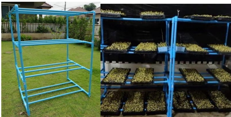
ขั้นตอนที่ ๔ นำชิ้นส่วนท่อ PVC ทั้งสองส่วน มาต่อกันให้มีลักษณะเป็นชั้นวางของ ดังภาพ
