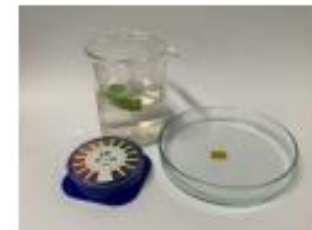
ภาพที่ 3 การวัดความเป็นกรด-เบส (pH) ของน้ำ
