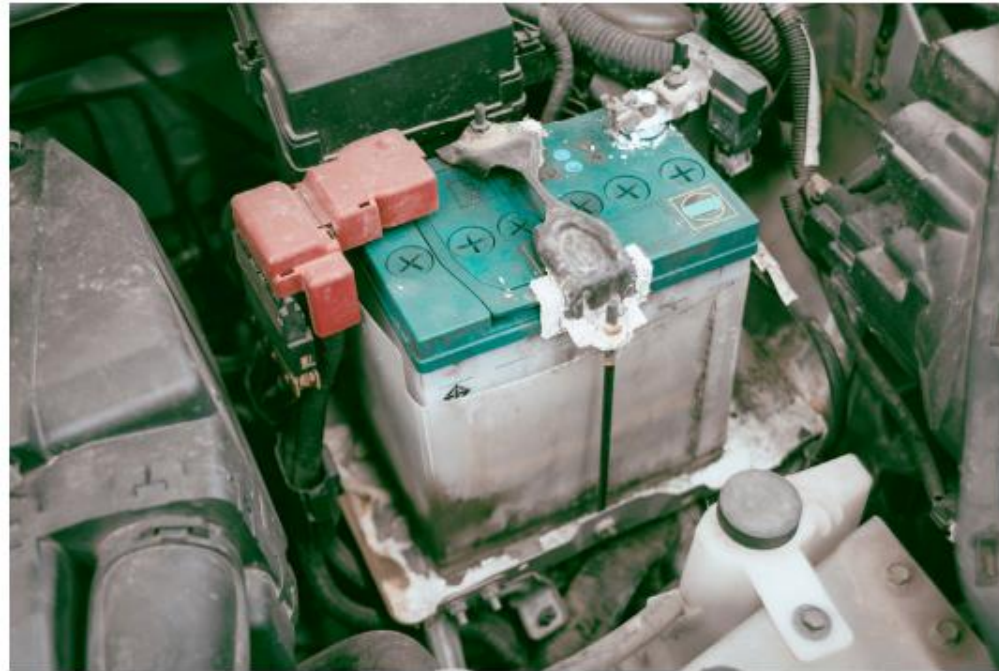
ภาพที่ 3 การกัดกร่อนตะกั่วเนื่องจากกรดซัลฟิวริกในแบตเตอรี่
