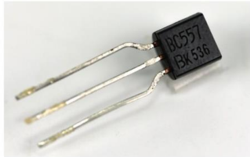
ภาพที่ 3 สัญลักษณ์ของทรานซิสเตอร์ชนิด PNP และตัวอย่างทรานซิสเตอร์เบอร์ BC557
