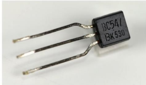
ภาพที่ 2 สัญลักษณ์ของทรานซิสเตอร์ชนิด NPN และตัวอย่างทรานซิสเตอร์เบอร์ BC547
