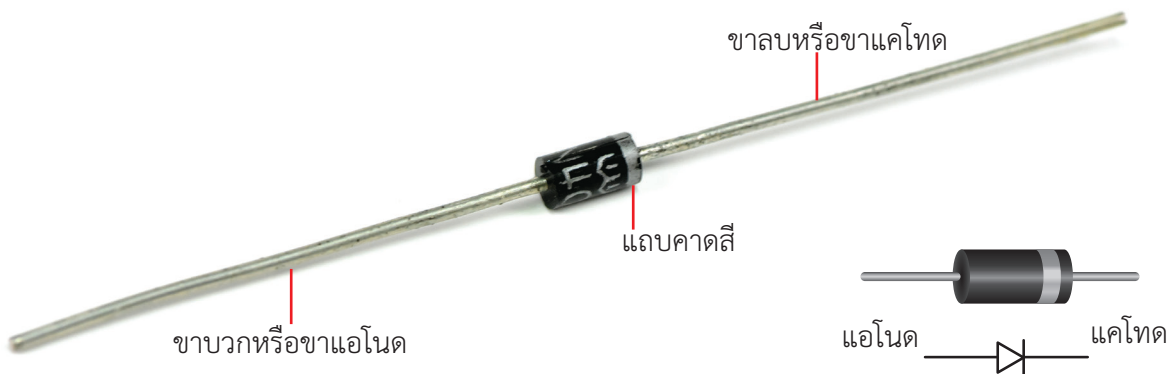
ภาพที่ 2 ไดโอดธรรมดาและสัญลักษณ์ในวงจรไฟฟ้า
