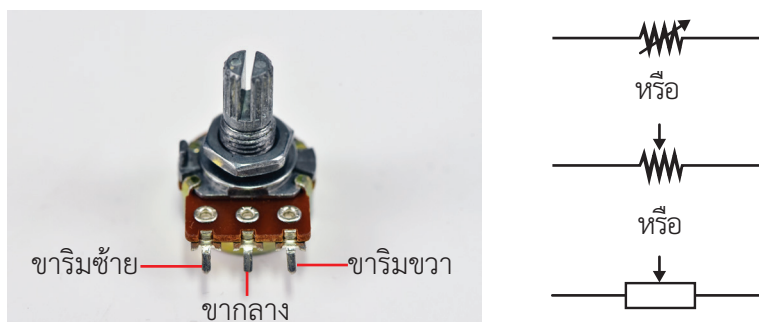
ภาพที่ 4 ตัวต้านทานแปรค่าได้และสัญลักษณ์ในวงจรไฟฟ้า
