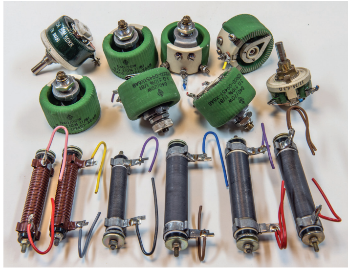
ที่มา : Hannes Grobe ภาพที่ 7 ตัวต้านทานแปรค่าได้ชนิดต่าง ๆ
