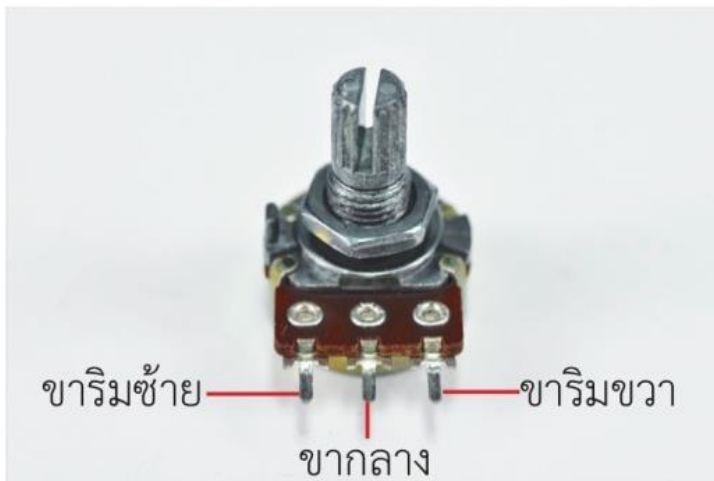
ภาพที่ 4 ตัวต้านทานแปรค่าได้และสัญลักษณ์ในวงจรไฟฟ้า
