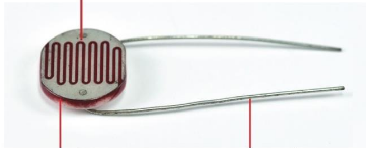
ภาพที่ 9 ตัวต้านทานแปรค่าตามแสงและสัญลักษณ์ในวงจรไฟฟ้า
