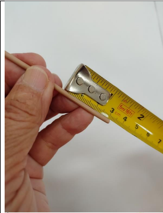
ขั้นตอนที่ ๒ วัดความยาวของสายที่ต้องการปอกออก เช่น ๒-๓ เซนติเมตร
