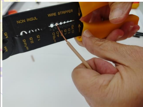
ขั้นตอนที่ ๓ นำสายไฟไปวางในร่องของคีมปอกสาย จับแล้วดึงให้ฉนวนหุ้มสายไฟหลุดออกมาให้เหลือแค่ทองแดงยาว ประมาณ ๓ เซนติเมตรตามที่วัดไว้
