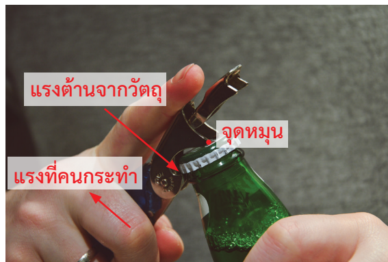
ภาพที่ 4 ตัวอย่างอุปกรณ์หรือเครื่องมือที่ใช้หลักการของคานที่พบในชีวิตประจำวัน
