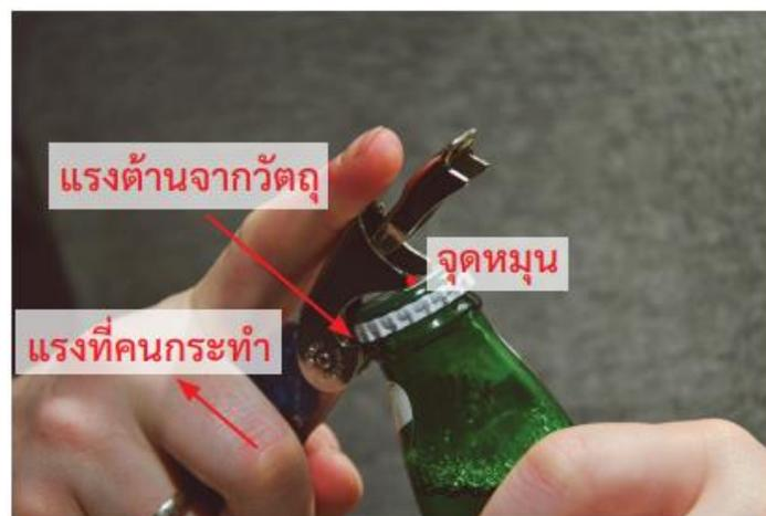
ภาพที่ 4 ตัวอย่างอุปกรณ์หรือเครื่องมือที่ใช้หลักการของคานที่พบในชีวิตประจำวัน
