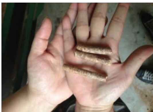
ภาพที่ 12 ตัวอย่างเชื้อเพลิงชีวมวลอัดแท่ง ที่มา : กรมพัฒนาพลังงานทดแทนและอนุรักษ์พลังงาน
