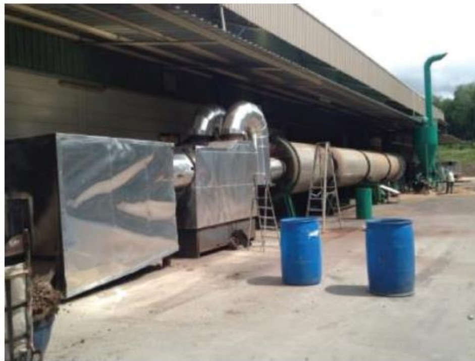
ภาพที่ 10 ตัวอย่างเครื่องอบไล่ความชื้นวัตถุดิบ ที่มา : กรมพัฒนาพลังงานทดแทนและอนุรักษ์พลังงาน
