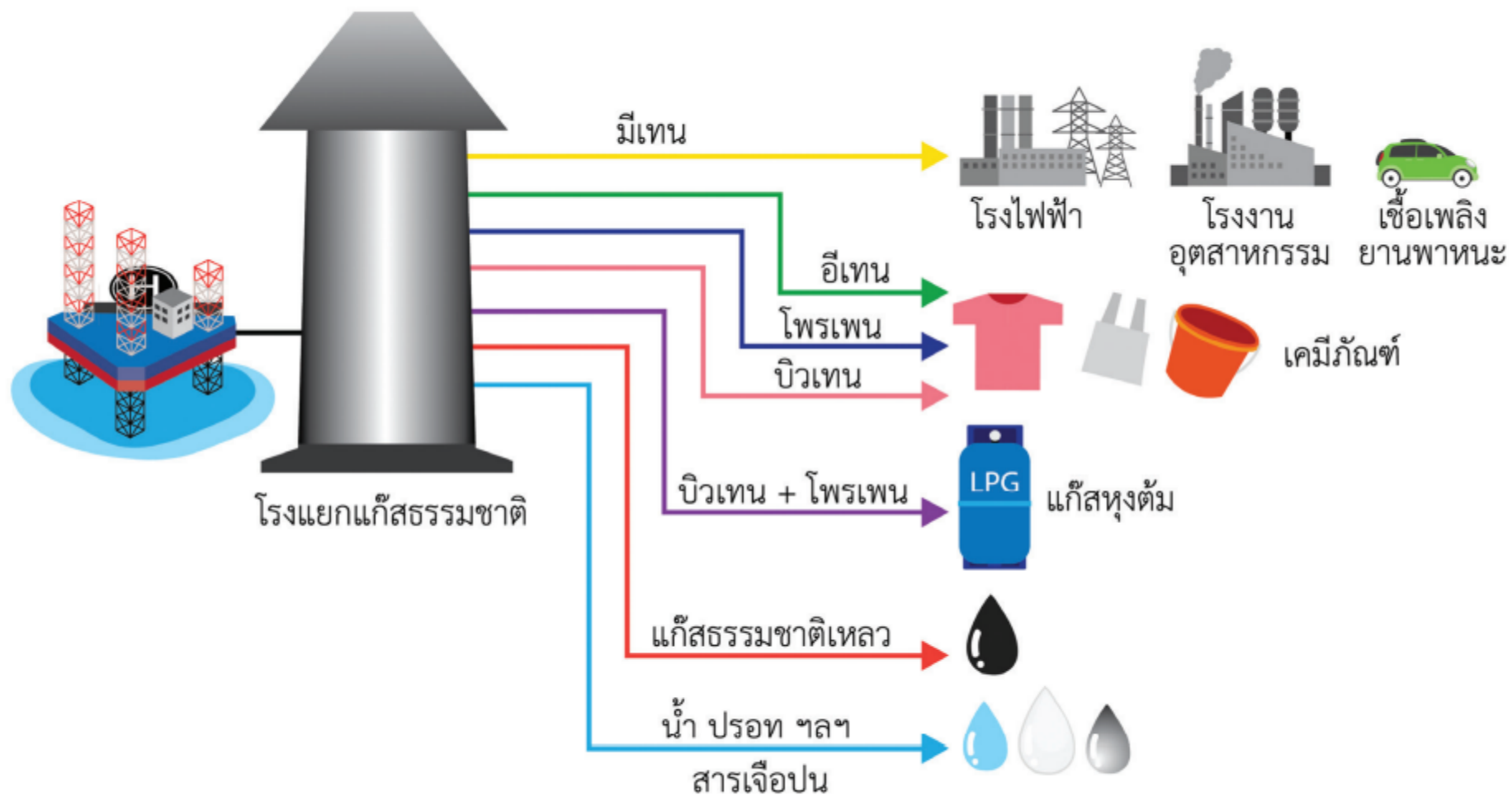
ภาพที่ 2 กระบวนการแยกแก๊สธรรมชาติและผลิตภัณฑ์ที่ได้
