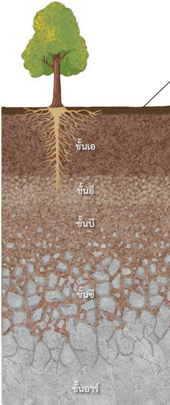
ภาพที่ 2 ชั้นหน้าตัดดินที่มีการพัฒนาอย่างสมบูรณ์ มีชั้นดินจำนวน 6 ชั้น
