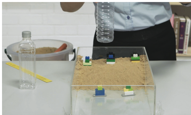
การเตรียมปล่อยน้ำไปยังที่ลาดเชิงเขาจำลอง
