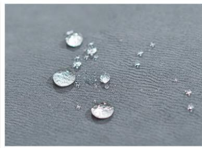
รูป 2 เสื้อผ้านาโน ป้องกันการเปียกชื้น ลดรอยยับ ช่วยยับยั้งแบคทีเรีย
