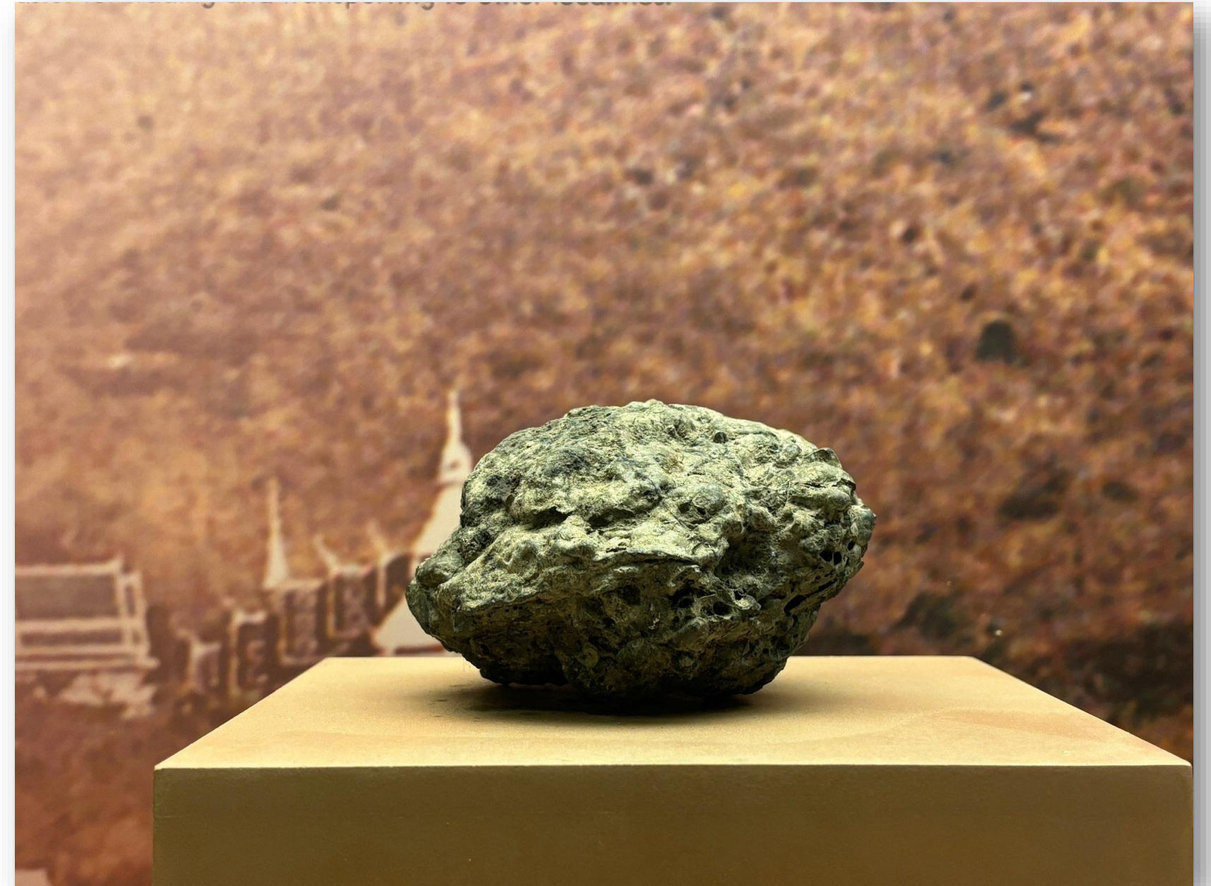
ตะกั่วแร่ทองแดง (เศษชิ้นแร่ที่ไม่ต้องการจากการถลุงทองแดง)
