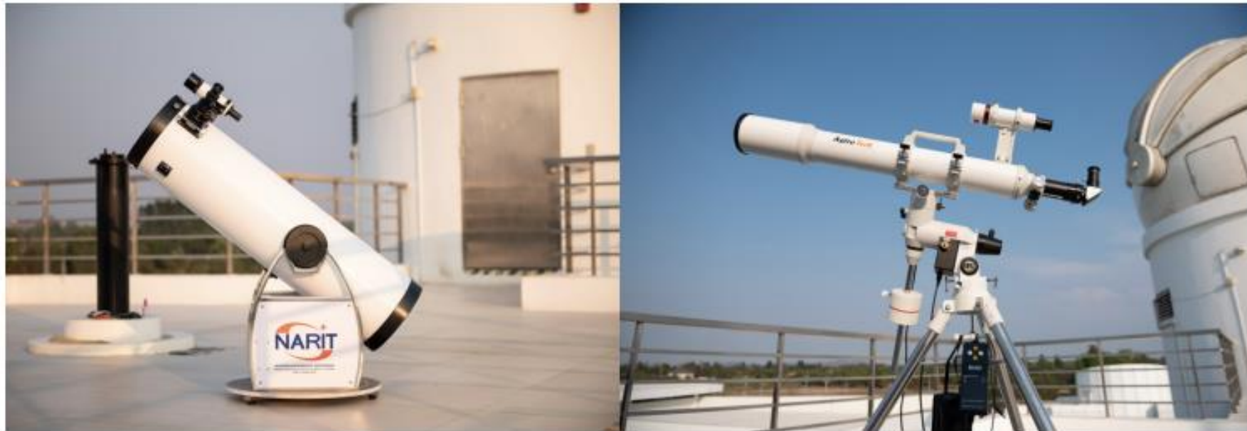
ภาพที่ 1 กล้องโทรทรรศน์สะท้อนแสง (ซ้าย) และกล้องโทรทรรศน์หักเหแสง (ขวา)
