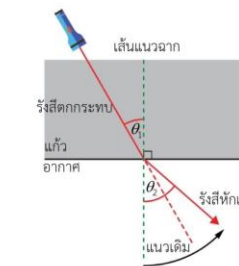
ภาพที่ 2 การหักเหของแสงเมื่อแสงเคลื่อนที่จากตัวกลางที่อัตราเร็วของแสงน้อยกว่าไปยังตัวกลางที่อัตราเร็วของแสงมากกว่า
