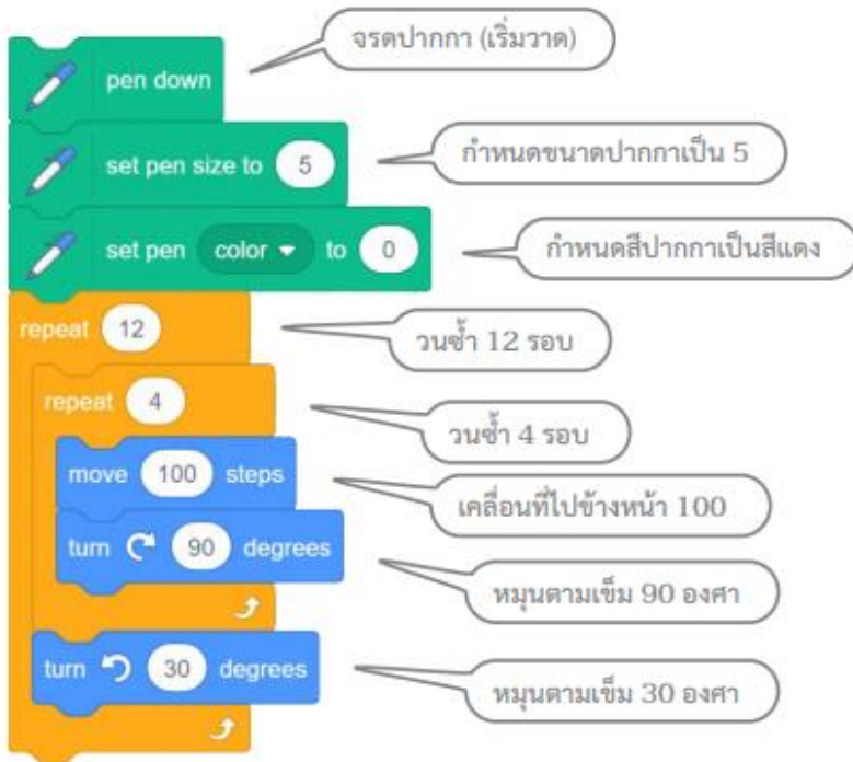
ภาพที่ 5 ตัวอย่างการใช้งานคำสั่ง repeat ( ) ซ้อนกัน
