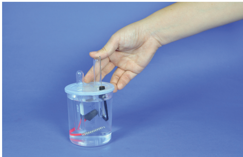
ภาพการดันหลอดแก้วและจุกยางออกทางด้านล่างของฝาครอบ
