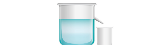
ภาพที่ 10 การจัดวางภาชนะก่อนการหาปริมาตรของวัตถุ
