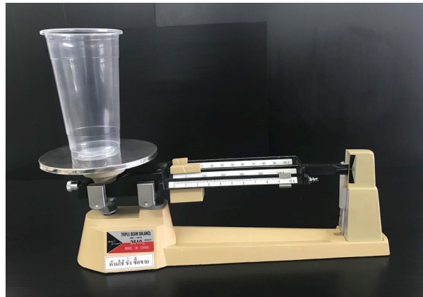
ภาพที่ 4 การชั่งมวลของภาชนะด้วยเครื่องชั่งแบบคานสามแขน
