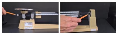
ภาพที่ 3 การปรับคานของเครื่องชั่งแบบคานสามแขนให้เข็มชี้อยู่ในตำแหน่งสมดุล
