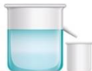
ภาพที่ 10 การจัดวางภาชนะก่อนการหาปริมาตรของวัตถุ
