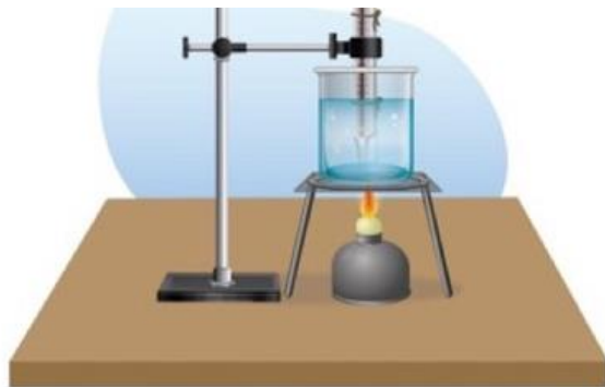
ภาพที่ 5 การจัดอุปกรณ์เพื่อหาจุดหลอมเหลว
