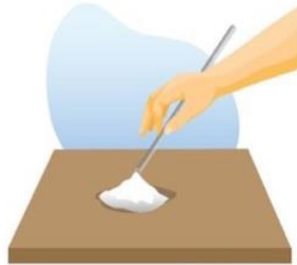
ภาพที่ 2 การบรรจุสารลงในหลอดคะปิลารี
