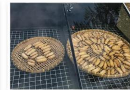
รูป 3 ตู้อบพลังงานแสงอาทิตย์ ทำให้สามารถเพิ่มระยะเวลาในการเก็บ และเพิ่มมูลค่าให้กับสินค้าทางการเกษตร
