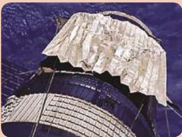
รูปที่ ๔๒ ฉนวนหุ้มยาน Skylab ที่มา : NASA
