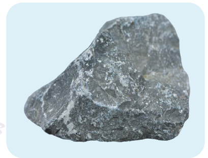
หินปูน มีผลึกขนาดเล็ก เมื่อนำไปเผา แล้วบดให้เป็นผง แล้วนำไป ผสมน้ำจะเชื่อมประสานวัสดุได้
