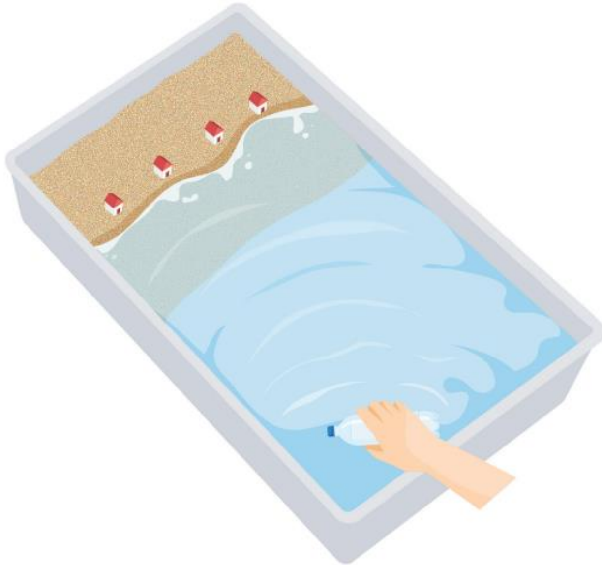
การจำลองคลื่นโดยกวดขวางน้ำในแนวตั้งและปล่อย
