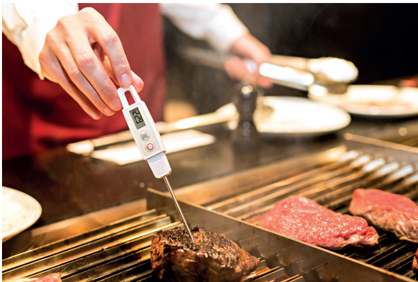
การใช้เทอร์มอมิเตอร์แบบเทอร์มอคัปเปิลวัดอุณหภูมิของอาหาร ภาพที่ 1 เทอร์มอมิเตอร์ชนิดต่าง ๆ
