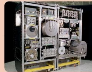
รูปที่ ๔๑ เครื่องกรองน้ำบนยานอวกาศ ที่มา : NASA
