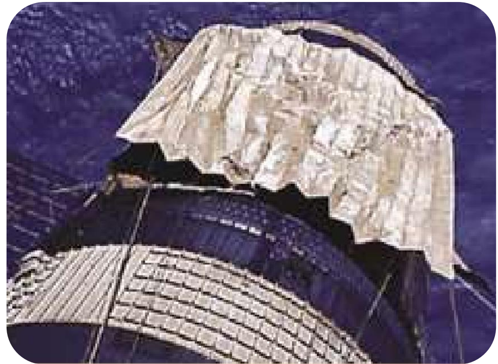
รูปที่ 42 ฉนวนหุ้มยาน Skylab ที่มา : NASA
